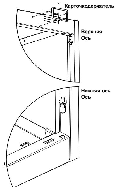
Установить карточкодержатель, а также верхнюю и нижнюю пружинные петли в отверстия крыши и дна соответственно, согласно схеме.
