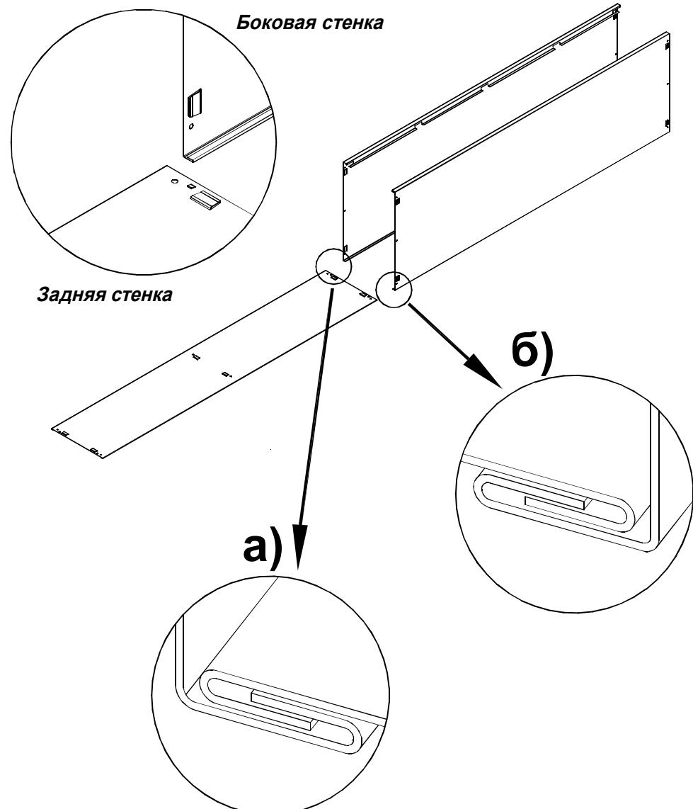
**2** При установке дна и крышки на корпусе необходимо обеспечить совпадение выступов в углах боковых стенок с прямоугольными отверстиями выполненными на сгибе крышки и дна.
