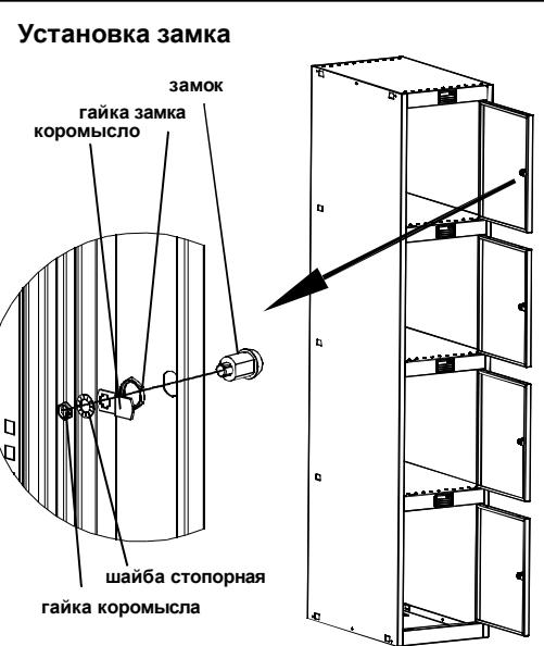
**ВАЖНО!** При наличии вертикального люфта двери, необходимо устраниć его, путем подкладывания регулировочной шайбы(входит в комплектацию) под ось.
